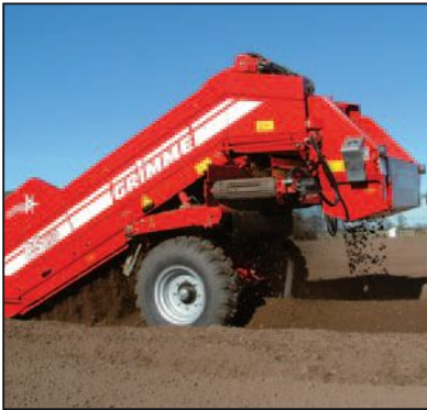
Todos los modelos están equipados de forma estándar con una cinta de descarga de solo 22 mm de distancia de varilla.
