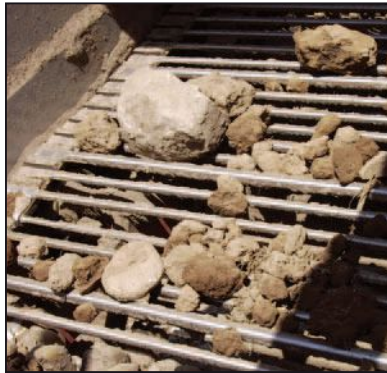
Una de cada seis varillas tiene un diámetro de 16 mm. Esto ofrece tres ventajas decisivas: Se optimiza el transporte de la tierra sobre las cintas de criba, se apoya la rotura de terrones y se obtiene una mayor estabilidad global de la cinta con piedras grandes.
